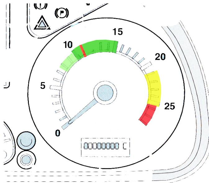
**Světle zelené pole** – možno využít při jízdě na rovině při udržování rychlosti. Při částečném zatížení klesá spotřeba paliva s otáčkami. Pokud jsou otáčky motoru pod 1000 ot/min pracujte s plynem velmi citlivě. Plný plyn až od 1000 ot/min!
